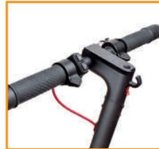
Monopattino sicuro, resistente, maneggevole e completo di tutto ciò che serve. Acceleratore a destra e a sinistra la leva che gestisce il freno elettronico anteriore con recupero dell'energia. App per verificare tutti i parametri, pin di sicurezza per bloccare il monopattino e allarme in caso di furto.
